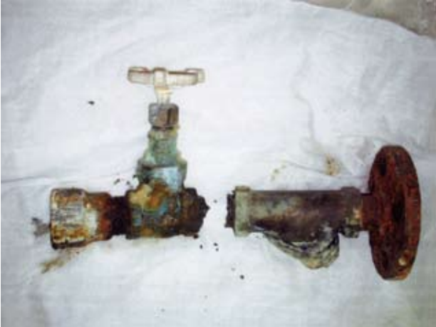
図1 破断した配管バルブ
